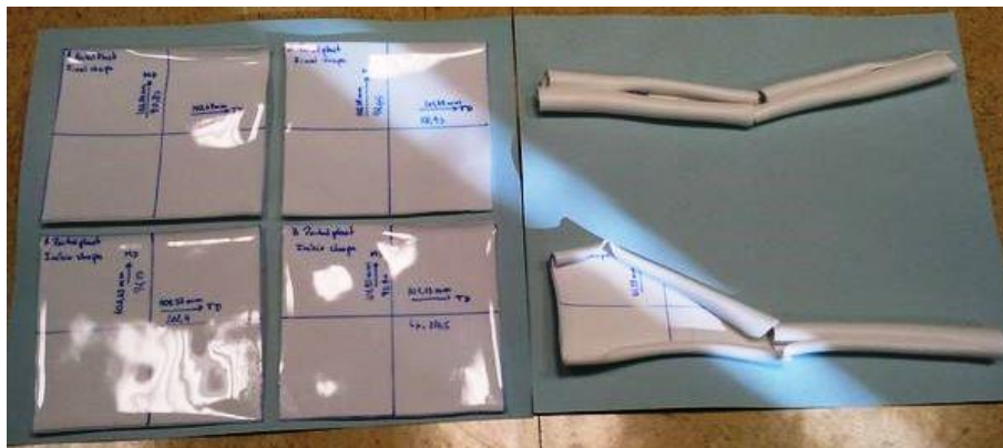
Extrusão: teste de contração em chapas
