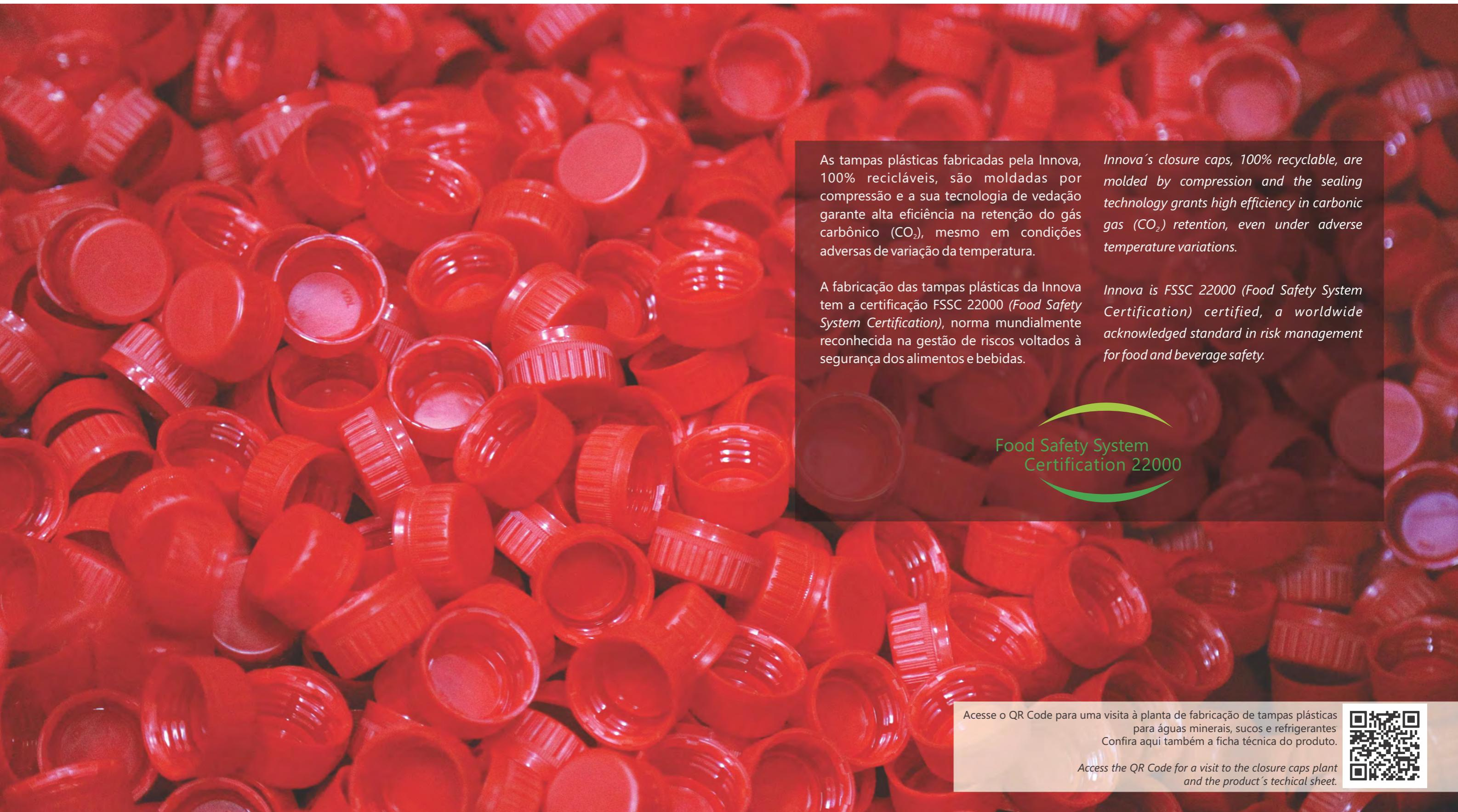
As tampas plásticas fabricadas pela Innova, 100% recicláveis, são moldadas por compressão e a sua tecnologia de vedação garante alta eficiência na retenção do gás carbônico ( $\text{CO}_2$ ), mesmo em condições adversas de variação da temperatura.
