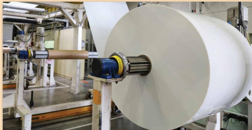
LAMINADOS PLÁSTICOS EM BOBINAS DE POLIESTIRENO (PS) E POLIPROPILENO (PP)
