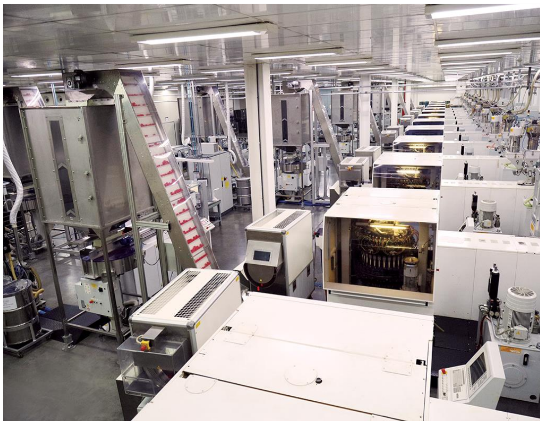
Unidade I, Manaus (AM): fabricação das tampas plásticas para águas minerais, sucos e refrigerantes.
