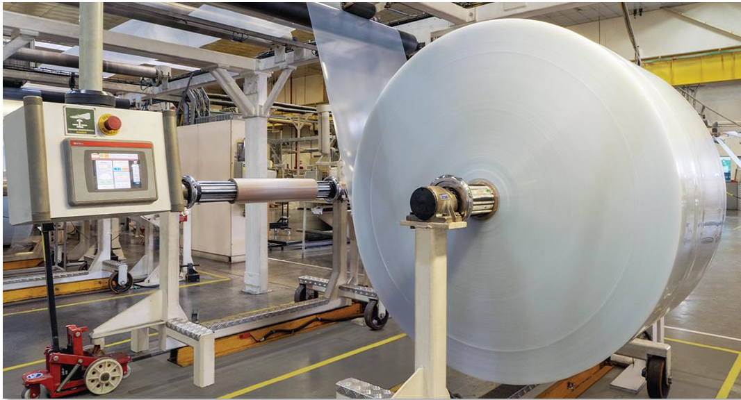
Unidade I, Manaus (AM): fabricação dos laminados plásticos em bobinas de poliestireno (PS) e polipropileno (PP).
